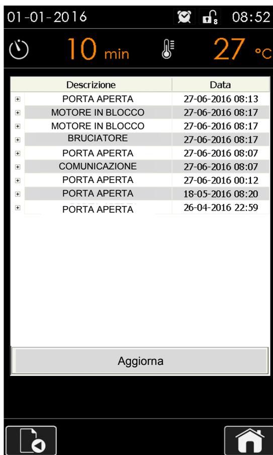
Questa schermata elenca tutti gli avvisi e tutti gli allarmi visualizzati sul display. Oltre alla descrizione viene riportata anche data e ora dell'avvenuta segnalazione. Premendo sul tasto "+" è possibile visualizzare, anche, data e ora dello spegnimento dell'allarme o dell'avviso in oggetto.
